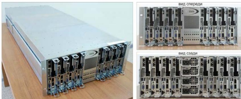
Рис. 1. Внешний вид сервера с плотной компоновкой
