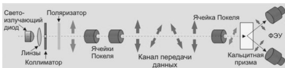
Рис. 1. Схема практической реализации квантовой криптографии
