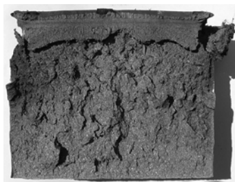
Рис. 1. Продольная резка стального цилиндра \varnothing 120 \times 100 мм: а – заряд 140 \times 140 \times 4 мм из ТГ5/5, б – разделенный цилиндр, в – сечение реза
