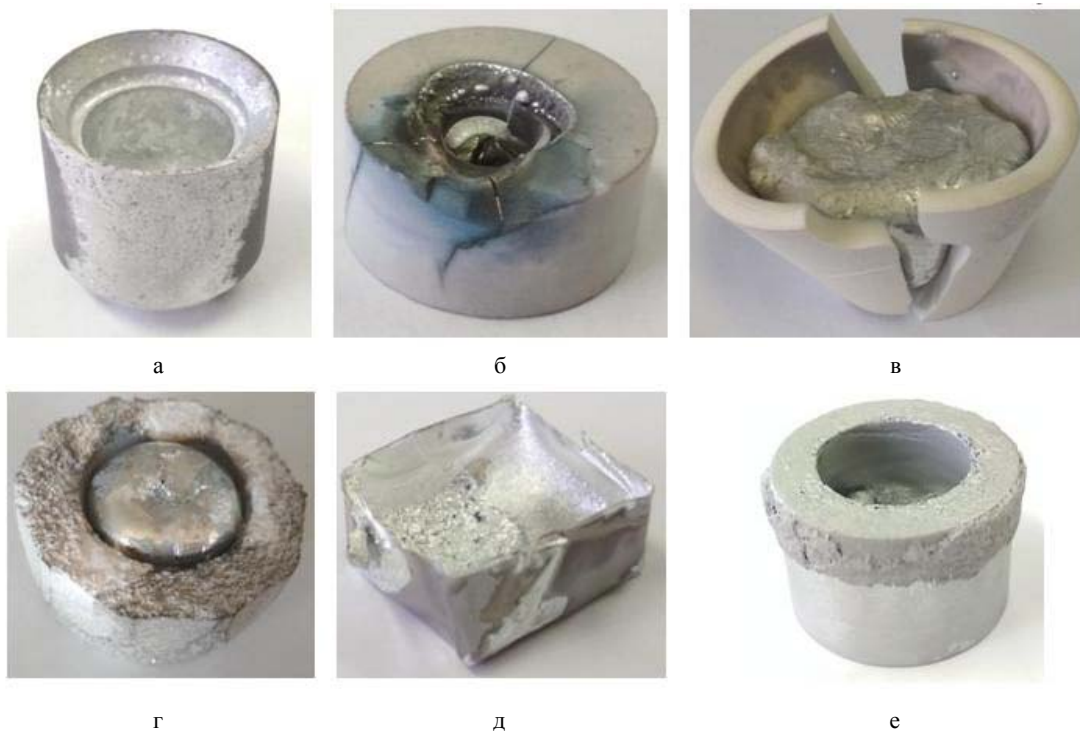
Рис. 2. Тигли – лайнеры для напыления алюминия на установке электронно – лучевого испарения «Оратория - 9М»: а – лайнер из диборида титана; б – лайнер из керамики «Кортим»; в – литой лайнер из корунда; г – прессованный лайнер из корунда; д – лайнер-лодочка из тантала; е – лайнер из молибдена
