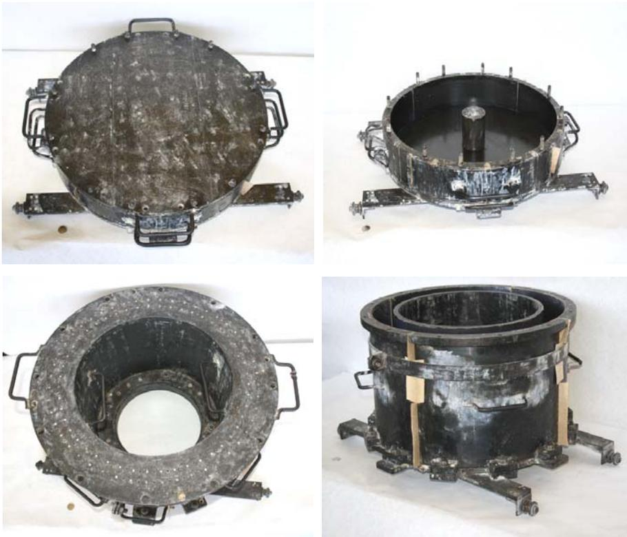
Рис. 1. Ограничительные формы для получения заготовок из «Сферолита»
