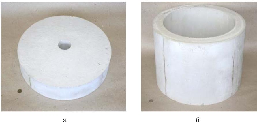
Рис. 2. Внешний вид заготовок из «Сферолита»: а – в виде диска; б – в виде цилиндра
