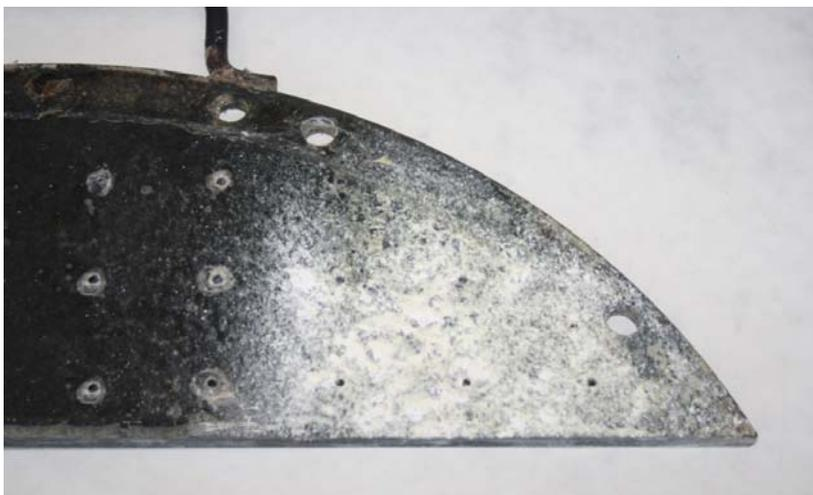
Рис. 4. Поверхность ограничительной формы с защитным фторопластовым покрытием
