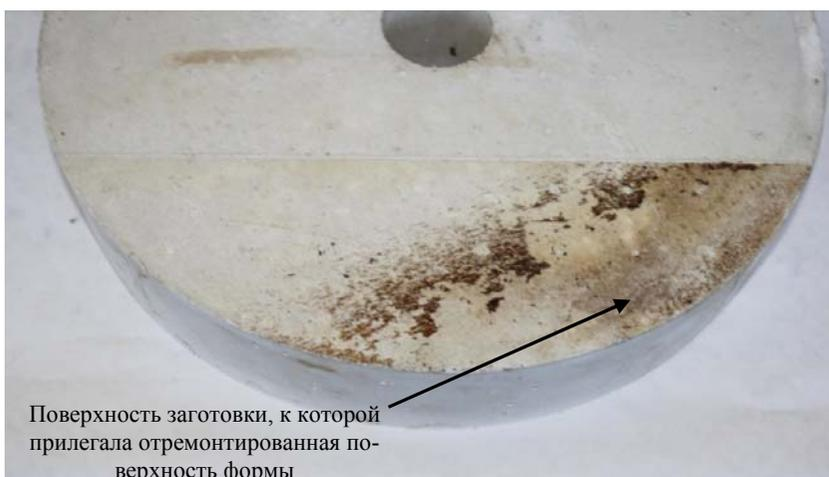
Рис. 6. Участок поверхности вспененной заготовки «Сферолит»
