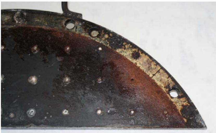
Рис. 5. Поверхность отремонтированной ограничительной формы после изготовления заготовки
