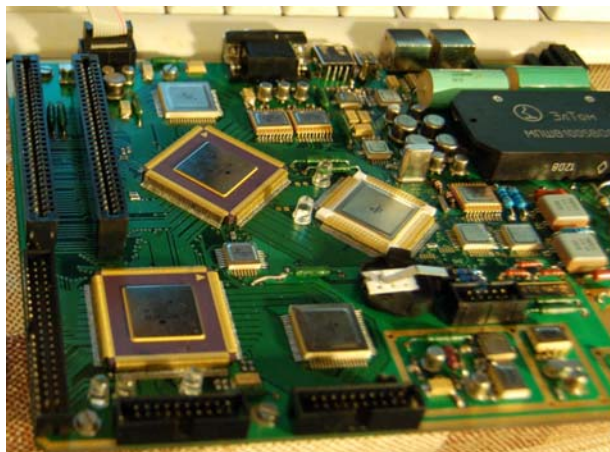
Рис. 4. Макет узла устройства, собранного на ПЛИС
