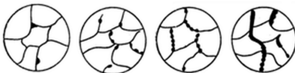
Рис. 3. Межзеренное накопление повреждений в виде зарождения и слияния пор
