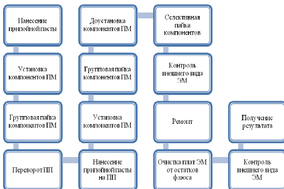
Рис. 6. Структурная схема смешанного монтажа на предприятии РФЯЦ-ВНИИЭФ
