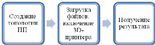
Рис. 3. Структурная схема изготовления ПМП на 3D-принтере
