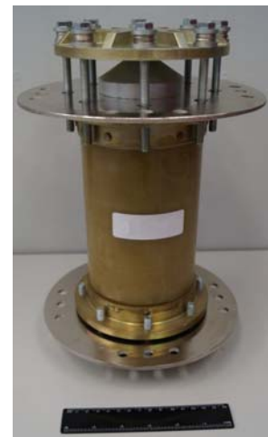
Рис. 2. Внешний вид полупроводникового коммутатора для модуля СНКЭЭ
