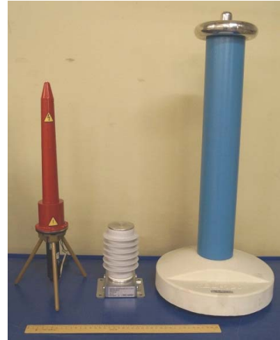
Рис. 2. Высоковольтные омические делители напряжения (слева направо) киловольтметра В7-40, модуля СНКЭЭ и киловольтметра КВЦ-120
