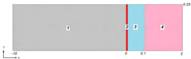
Рис. 2. Схема расчетной области для моделирования развития РТ и РМ неустойчивостей. 4 подобласти: 1 – для учета отраженной УВ (газ, \rho = 0,01 г/см 3 ), 2 – область энерговыделения, 3 – ударник (1,42 г/см 3 ) и 4 – углеродистая пена (0,1 г/см 3 ). Размеры указаны в мм
