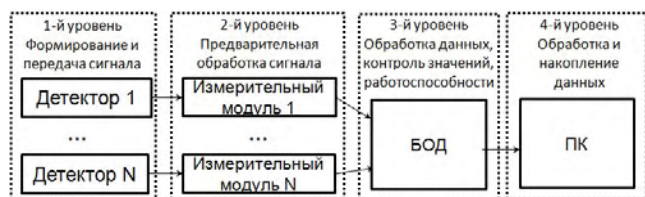
Рис. 1. Структура четырехуровневого измерительного комплекса
