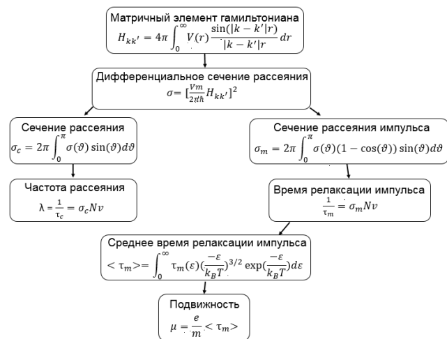
Рис. 5. Блок-схема алгоритма расчета подвижности и времени релаксации в приближении сферической однодолинной модели
