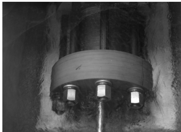
Рис. 2. Внешний вид соленоида, охлаждаемого жидким азотом
