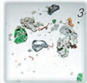
Разрушение электронной сборки при сверхвысоких перегрузках: 1 – импульс ускорения; 2, 3 – электронная сборка до и после воздействия
