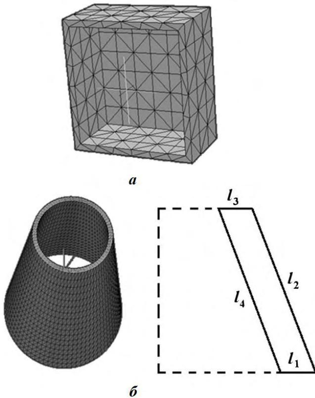
Рис. 16. Вспомогательные сетки для тонкостенного параллелепипеда (а) и тонкостенного усеченного конуса (б)
