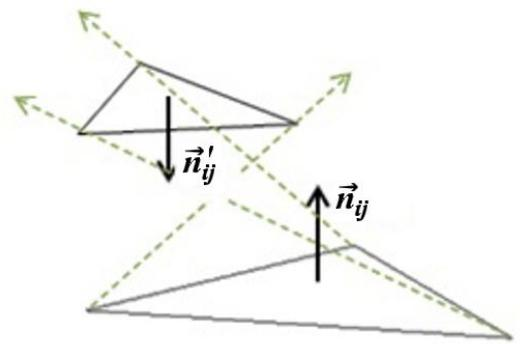
Рис. 8. Недопустимое положение треугольника после смещения узлов
