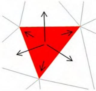
Рис. 2. Связи треугольников в структуре *узлы и треугольники*
