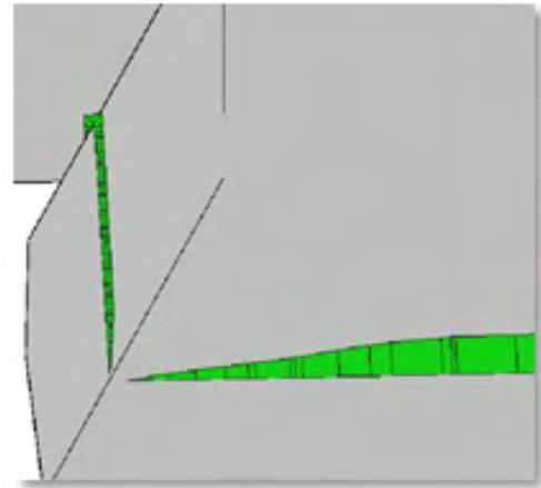
Рис. 10. Схлопывание поверхности на примере сечения призматического слоя
