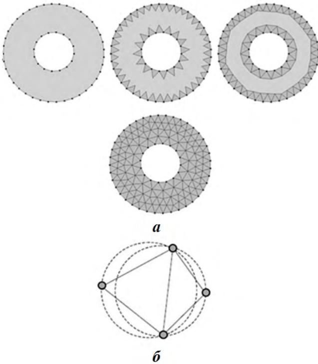
Рис. 13. Построение сетки: *а* — итерационное построение методом подвижного фронта; *б* — критерий Делоне на примере пары симплексов
