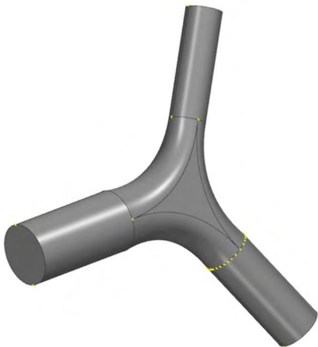
Рис. 19. Геометрия соединительной детали трубопровода
