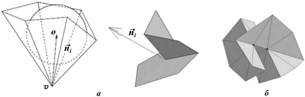
Рис. 7. Особый узел: *a* — направление сдвига определено; *б* — направление сдвига не определено
