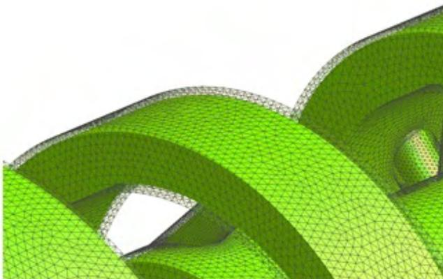
Рис. 5. Вид исходной сетки и смещенной поверхности
