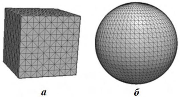
Рис. 14. Вспомогательная сетка на поверхности параллелепипеда (*а*) и сферы (*б*)
