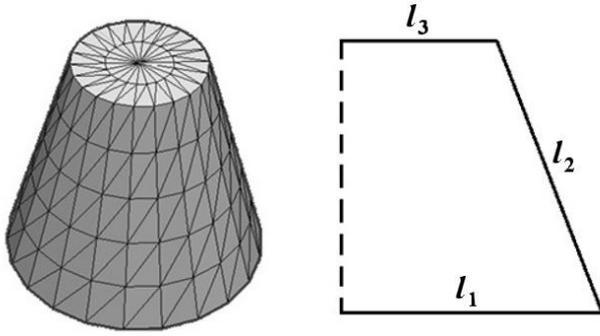
Рис. 15. Вспомогательная сетка на поверхности усеченного конуса
