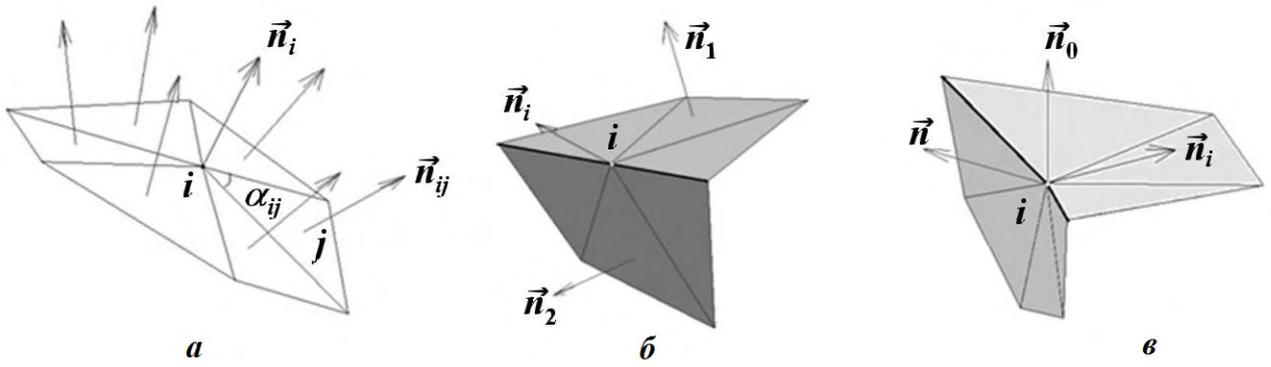
Рис. 6. Направления сдвига узла: *a* — на гладкой поверхности; *б* — в вершине ребер характерной кривой; *в* — на линии раздела границ
