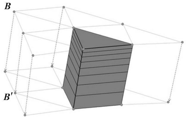
Рис. 12. Формирование призматических ячеек вблизи поверхности тела
