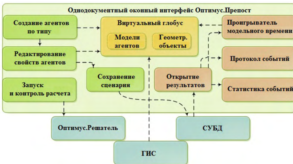
Рис. 3. Схема взаимодействия модулей препостпроцессора
