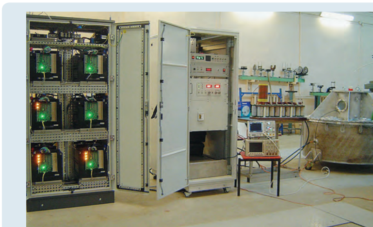
Мощный источник питания для электровакуумных приборов
