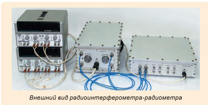
Внешний вид радиоинтерферометра-радиометра
