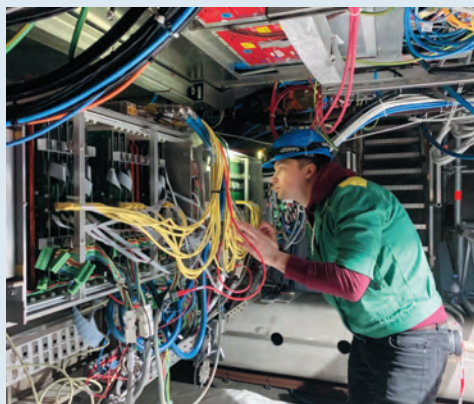
Проведение сервисных работ с калориметром PHOS: слева – с системой охлаждения, справа – с системой управления
