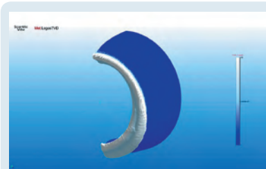
Форма ледяного нароста на мотогондоле летательного аппарата
