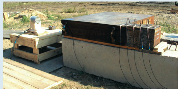
Постановка эксперимента по определению пробивной способности
