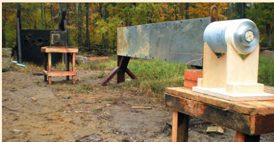
Постановка эксперимента по регистрации кумулятивной струи
