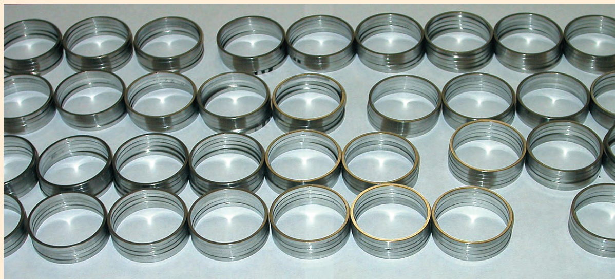
Партия деталей в виде колец из высокотемпературного антифрикционного материала
