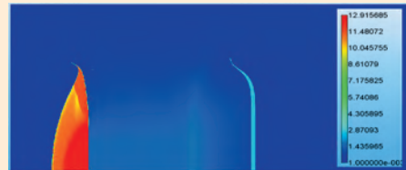
Поле плотности (г/см 3 ) в модельном расчете опыта по метанию алюминиевого лайнера толщиной 1 мм
