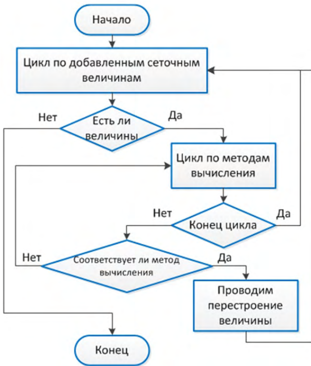
Рис. 5. Схема перестроения дополнительных сеточных величин
