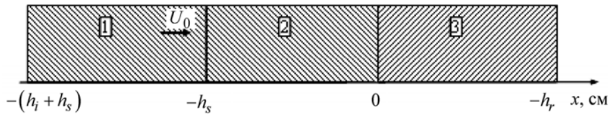
Рис. 6. Начальная геометрия задачи о размазывании фронта стационарной УВ: 1 – ударник; 2 – образец; 3 – опорная пластина
