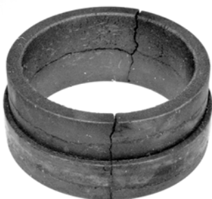
Рис. 13. Разрушенные топливные элементы реактора БР-1
