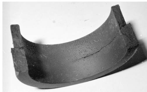
Рис. 13. Разрушенные топливные элементы реактора БР-1
