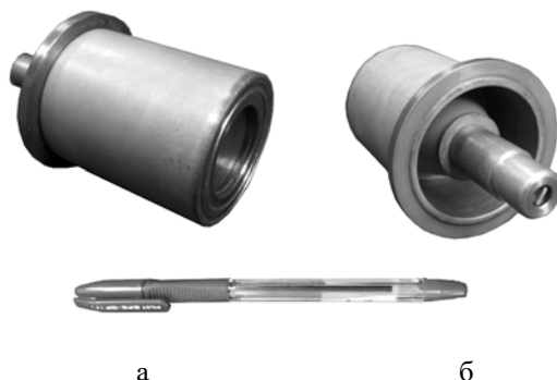
Рис. 3. Ускорительная трубка СНИТ-1000: а – вид сбоку, б – вид сзади
