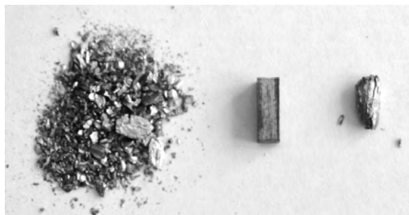
Рис. 2. Призматические образцы после выдержки в водороде при давлении 300 МПа и температуре 100 °С: а – в течение 1 ч; б – в течение 5 мин
