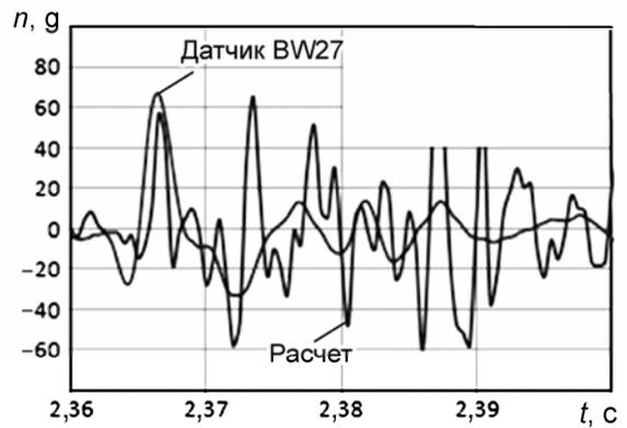
Рис. 3. Перегрузки при осевом падении ТУК-109Т
