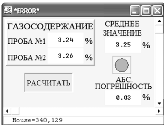
Рис. 6. Окно программы CRW32 для контроля точности (погрешности) двух последовательных результатов измерений
