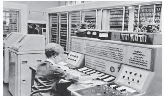
Ламповая ЭВМ М-20 производительностью 20000 операций в секунду
