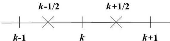
Аппроксимируем уравнение (1) с использованием разностной (конечно-элементной) схемы с сеточным шаблоном, содержащим узлы со значениями искомой функции в одном интервале сетки, а именно на концах и в центре ячейки. Для
