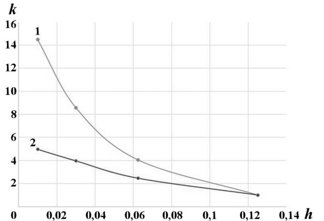
Рис. 2. Рост числа итераций при сгущении пространственной сетки: 1 — простая итерация; 2 — НС-метод
