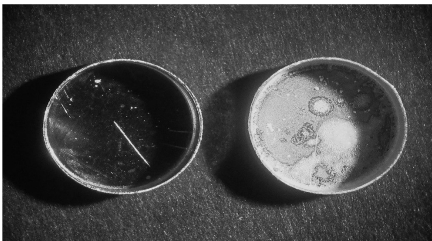
Рисунок 2. Внешний вид алюминиевых тиглей после опыта: слева – опыт с АУ; справа – с ДНА
