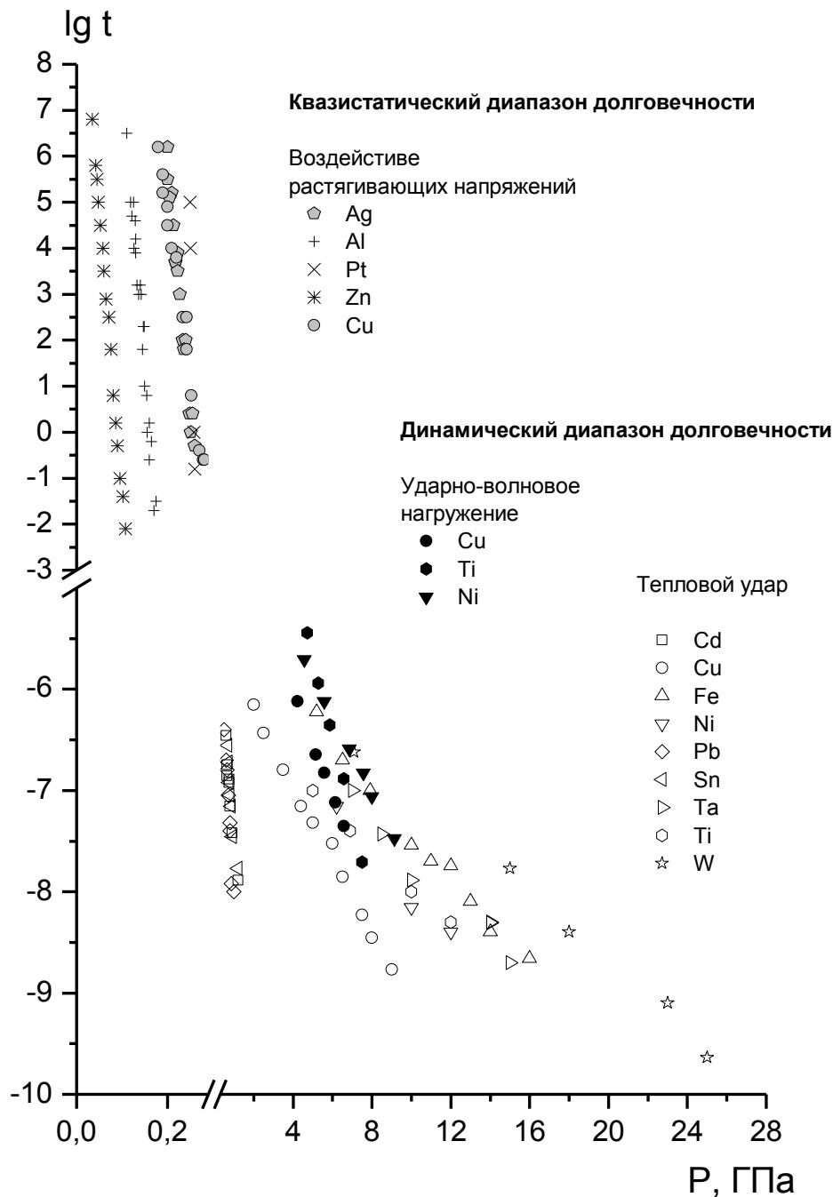
**Рисунок 1.** Временные зависимости долговечности металлов от критического давления, приводящего к разрушению, в квазистатическом и в динамическом диапазонах долговечности ( $t$  в секундах)  $\Delta t_1 = \Delta t_2; \Delta P_{дин} > \Delta P_{кв}$  [1-5]
