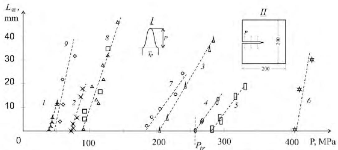
Рисунок 3. Зависимости длины проросшей трещины от амплитуды одиночного импульса нагрузки при длительности нагружения: 1 – известняк, 4,4 с; 2 – мрамор, 3,6 с; 3 – габбродиабаз, 3,6 с; 4 – песчаник, 3,6 с; 5 – гранит, 3,6 с; 6 – полимерный композит – 3 с; ПММА: 7 – 2 с; 8 – 4 с; 9 – 8,6 с [6-8]. Приведены форма импульса I и схема нагружения II
