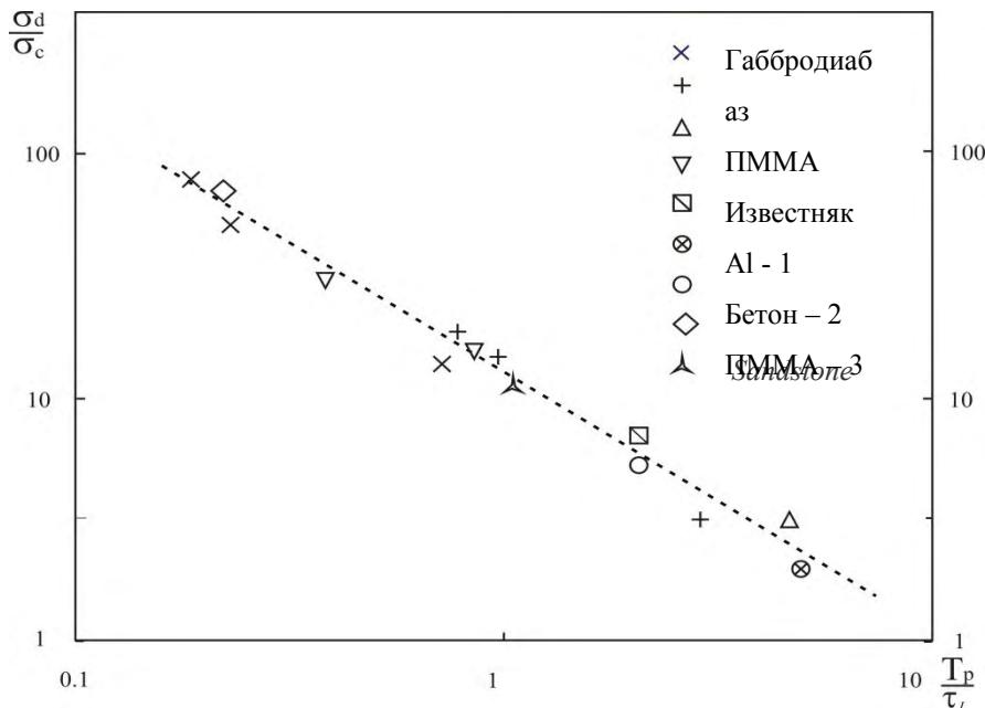
Рисунок 2. Зависимость разрушающих пороговых нагрузок от длительности импульса твердых тел при разных способах динамических нагружений [6, 7]
