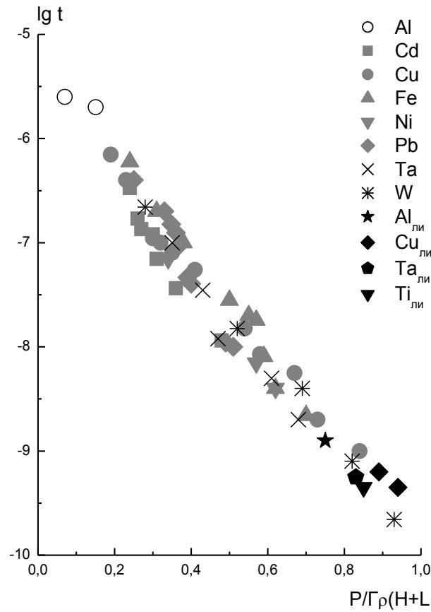
Рисунок 4. Временная зависимость процесса динамического разрушения [1]
