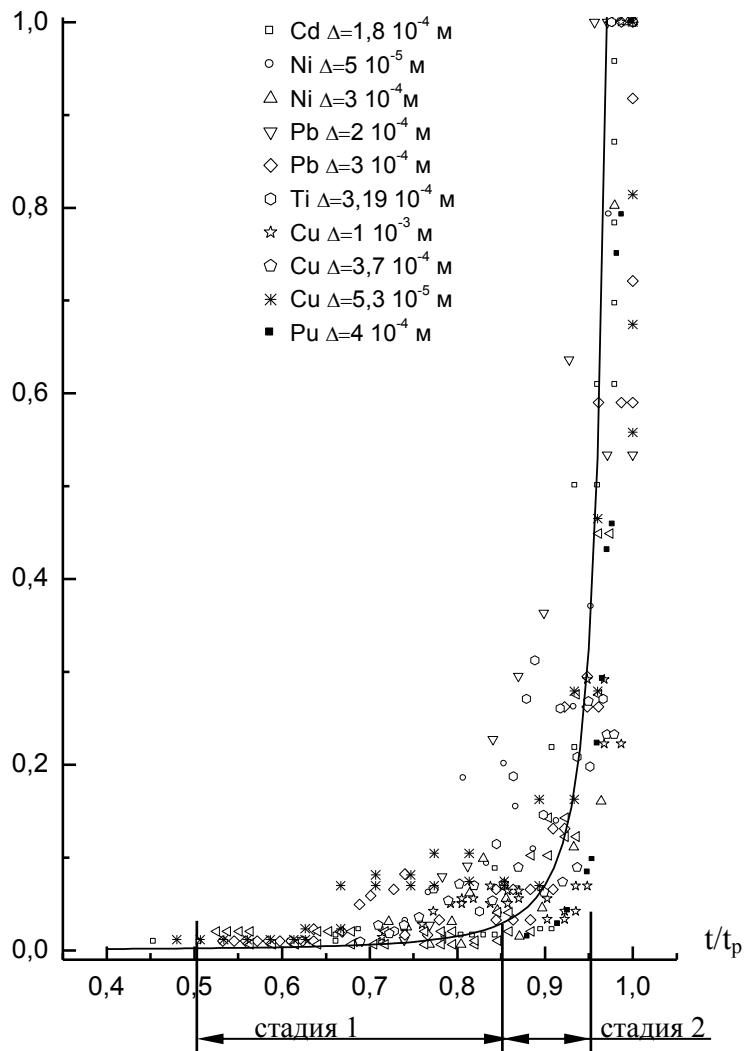
Рисунок 5. Скорость центрообразования ряда металлов разной толщины ( $\Delta$ )
