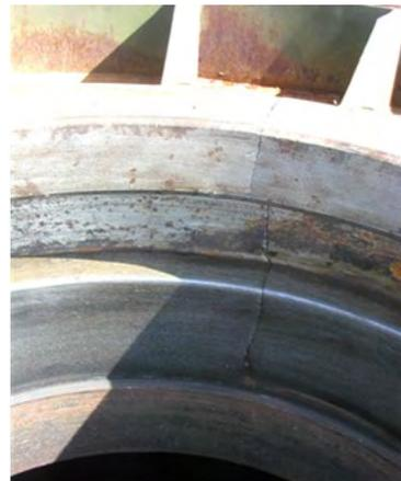
Трещина на патрубке загрузочной горловины
