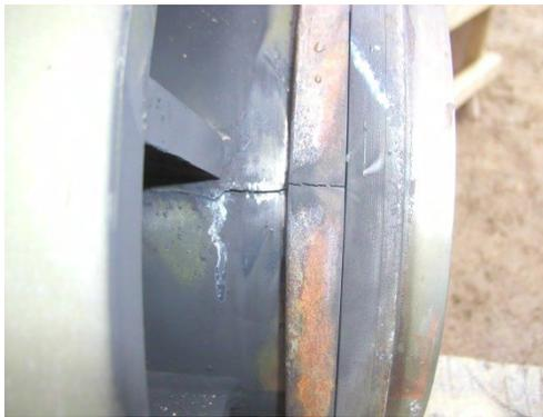
Трещина на патрубке радиографического ввода
