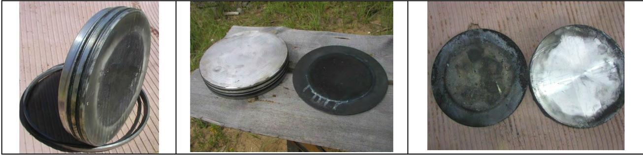
**Рисунок 13 . Крышки радиографических окон после экспериментов №2, № 4 и №6**
