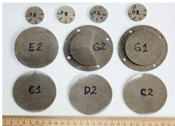
Рисунок 2. Образцы из стали изготовленные на 3D принтере
