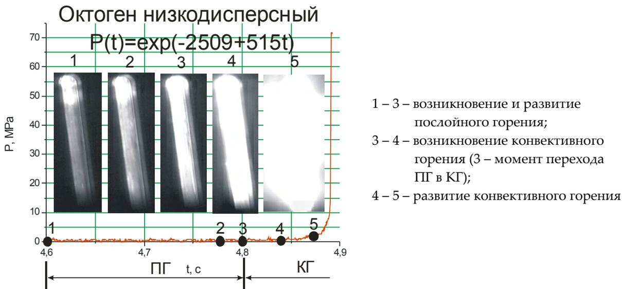
**Рисунок 3.** График изменения давления  $f=P(t)$  с отдельными видеокадрами записи процесса горения заряда из низкодисперсного октогена
