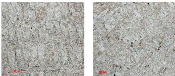
Рисунок 3. Структура материала АТ-нержавеющей стали, оптические снимки
