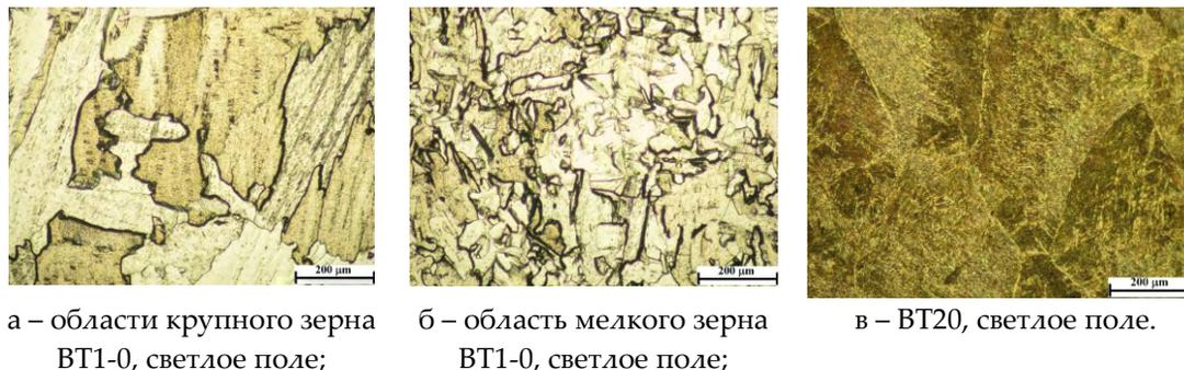
**Рисунок 2.** Исходная структура титановых сплавов марок ВТ1-0 и ВТ20
