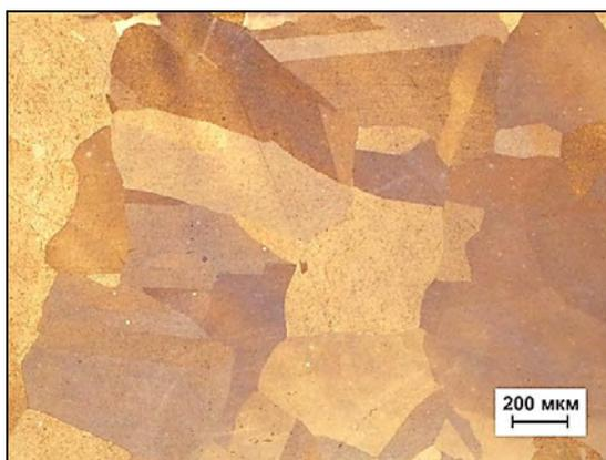
Рисунок 1. Фотография микроструктуры свинца в исходном состоянии
