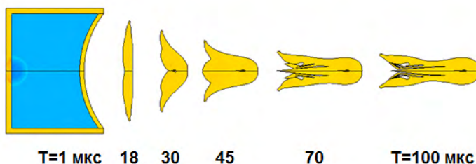
Рисунок 2. Функционирование снарядоформирующего заряда и получение высокоскоростного удлиненного элемента
