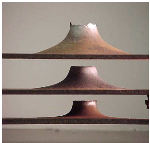
Рисунок 2. Прошивка трех, помещенных вместе 4.8-мм стальных пластин, водяным снарядом массой 240 г
