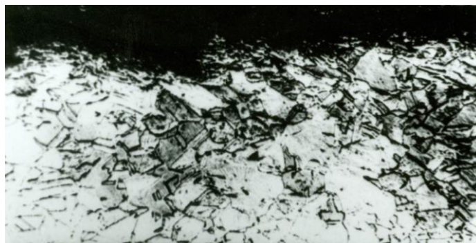
Рисунок 3. Микрошлиф контактной границы Al-Cu, d = 1 мм
