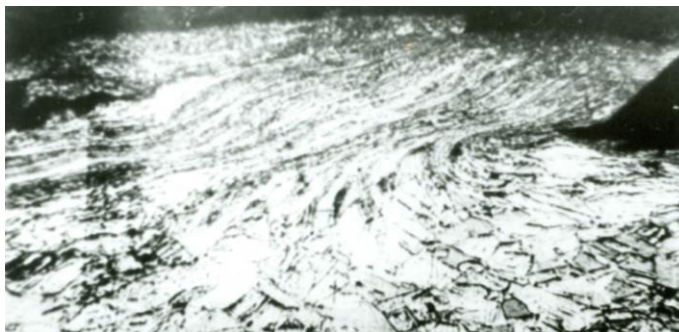
Рисунок 2. Микрошлиф контактной границы Al-Cu, d = 10 мм
