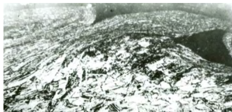
Рисунок 5. Микршлиф контактной границы Al-Cu, d = 10 мм
