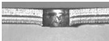
Рисунок 2. Фотографии продольного сечения преграды (слева) и ударника с выбитой «пробкой» (справа) после опыта B15 [10]
