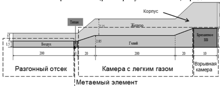
Рисунок 1. Общий вид начальной геометрии ЛГПР (размеры указаны в см)
