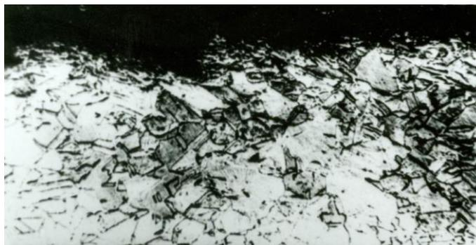
Рисунок 3. Микрошлиф контактной границы Al-Cu,  $d = 1$  мм
