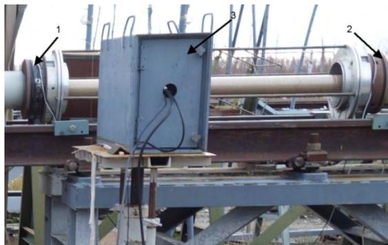
Рисунок 2. Общий вид измерительного участка: 1-измерительное сечение ИС1; 2-измерительное сечение ИС2; 3-рентгеновский аппарат
