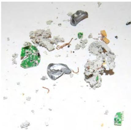
**Рисунок 8.** Фотография электронной сборки после испытаний в заливке из компаунда марки КПТД-1/1Т-5,5
