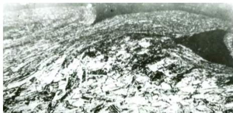
Рисунок 5. Микршлиф контактной границы Al-Cu,  $d = 10$  мм
