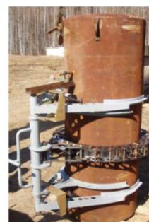
резак смонтирован на фрагмент опоры
