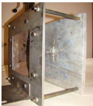
**Рисунок 5.** Сборка сеточного экрана с пластиной-свидетелем после эксперимента
