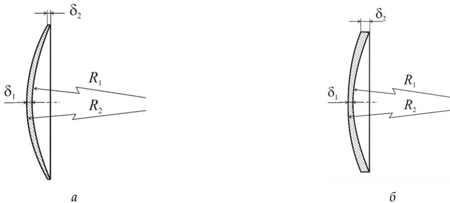
**Рисунок 3.** Варианты облицовок снарядоформирующих зарядов: а) дегрессивная; б) прогрессивная; радиусы:  $R_1$  –внутренней сферической поверхности;  $R_2$  –наружной сферической поверхности; толщина облицовки:  $\delta_1$  – в центре;  $\delta_2$  –в периферийной области
