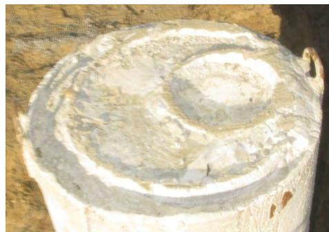
а) схема монтажа труб б) взаимное расположение труб в) макет залитый цементным раствором
