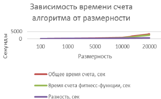
Рис. 2. Зависимость времени счета от размерности задачи для алгоритма в целом, для расчета фитнес функции и их разности
