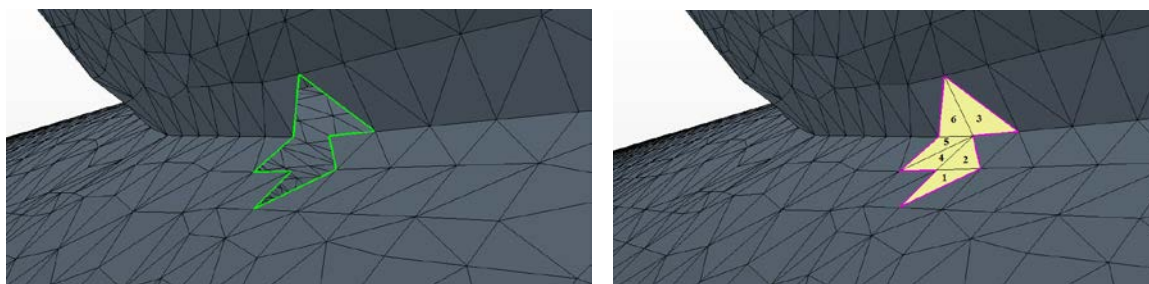
Рис. 17. Выделенный контур, с удаленными ячейками внутри него (слева) и триангуляция выделенного полигона (справа)
