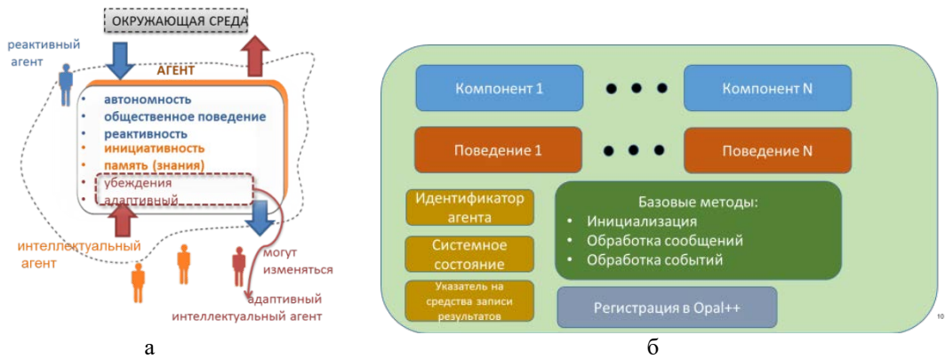
Рис. 2. Программный агент: а – логическое представление; б – представление в формате мультиагентного решателя
