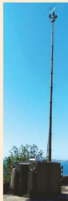
Внешний вид комплекта ИП-АПП в рабочем состоянии в режиме ретрансляции и управления по радиомодемному каналу
