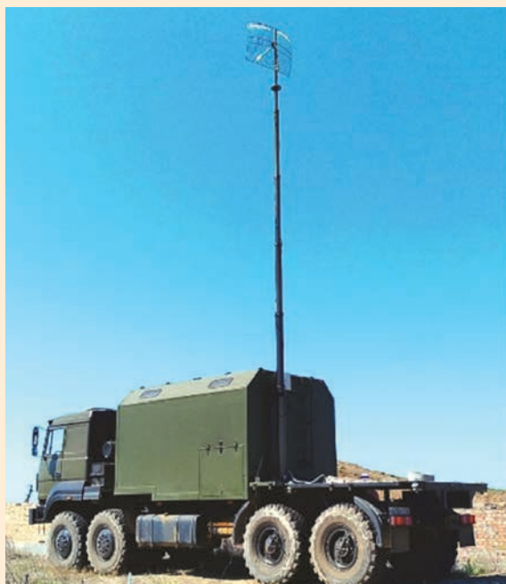
Внешний вид комплекта ИП-АПП в рабочем состоянии в режиме ретрансляции и управления по радиомодемному каналу
