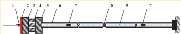
Схема постановки исследований: 1, 2 – взрывчатые материалы; 3 – ударник; 4 – алюминиевый крешер; 5 – переходник; 6 – нагружающий стержень; 7 – тензометрические датчики; 8 – образец; 9 – опорный стержень
