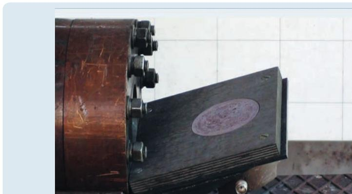
Расположение имитатора относительно сопла кислородо-водородной установки
