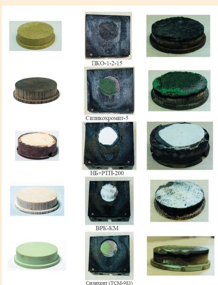
Образцы антенных вставок до и после испытаний
