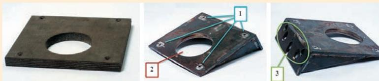
Составные части имитатора: 1 – отверстия для крепления теплозащитной пластины к кронштейну; 2 – окно под антенную вставку; 3 – отверстия для крепления кронштейна к кислородо-водородной установке
