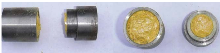
Рис. 9. Характер разрушения ВВ на основе ТАТБ при V_{нагр} = 38,4 - 44,8 м/с
