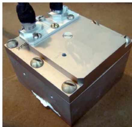
Рис. 2. Внешний вид прибора до и после ударного воздействия с формой, показанной на рис. 3: а – до удара, б – после удара
