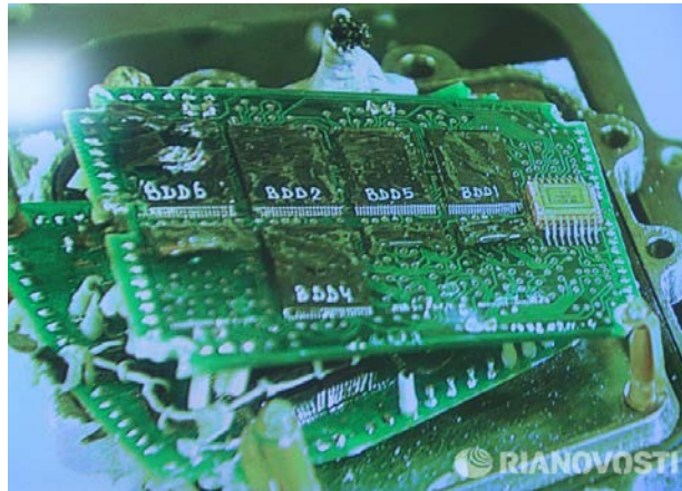
Рис. 1. Внешний вид ЗБН Су-24 после катастрофы
