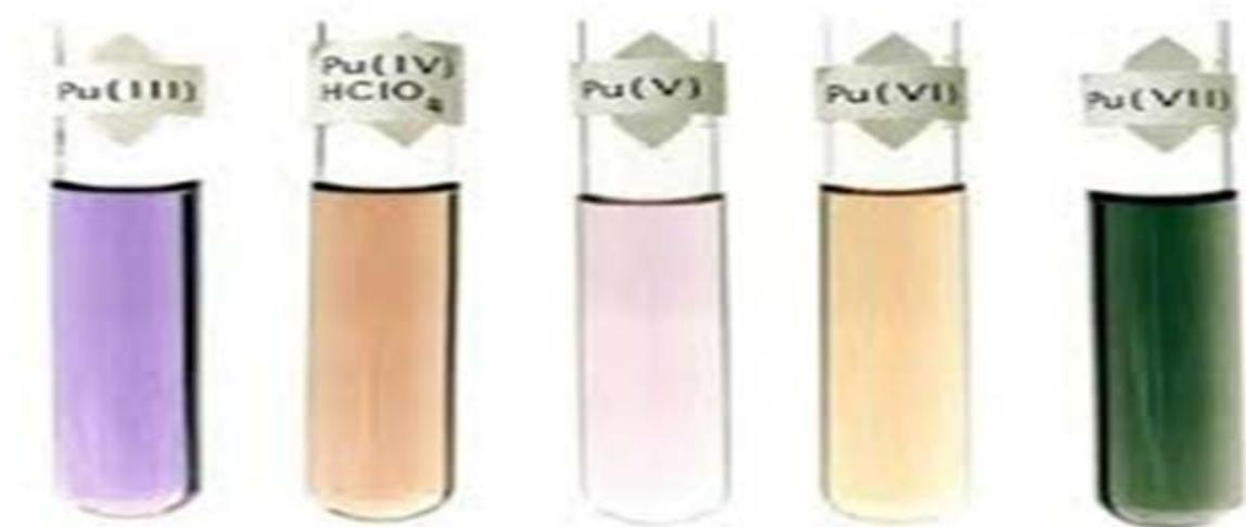
Рис. 5. Цвет различных водных растворов плутония
