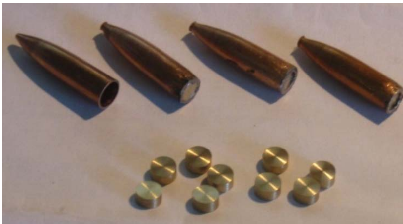
Рис. 1. Пули калибра 7,62×54 мм, изготовленные с применением материала 07PM02M
