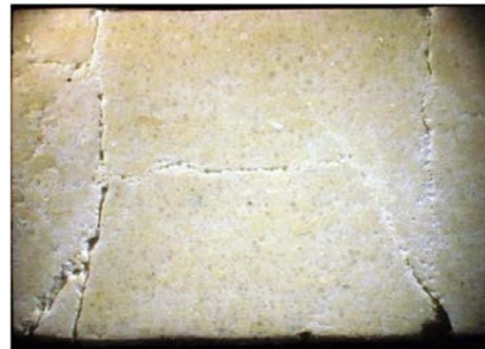
Рис. 5. Диаметральное сечение образца ВВ после опыта на локализованный сдвиг: опыт № 1, P = 31,4 кН, \dot{\epsilon} = 200 с -1 ( V_{\text{нагр}} = 4,0 м/с)
