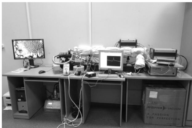
Рис. 1. Экспериментальная установка для исследования кинетики термического разложения энергетических материалов
