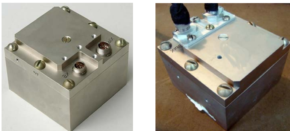
Рис. 2. Внешний вид прибора до и после ударного воздействия с формой, показанной на рис. 3: а – до удара, б – после удара
