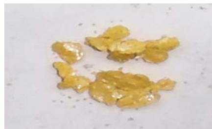
Рис. 7. Часть фрагментов образца из ВВ на основе ТАТБ после одного из опытов на динамическое сжатие
