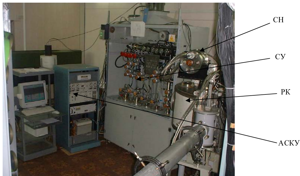
Рис. 7. Общий вид комплекса: СУ – система утилизации и контроля радиационной обстановки; СН – система наполнения; РК – реакционная камера
