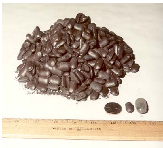
Рис. 3. DUAGG – стабилизированные DU агрегаты, спеченные с базальтом
