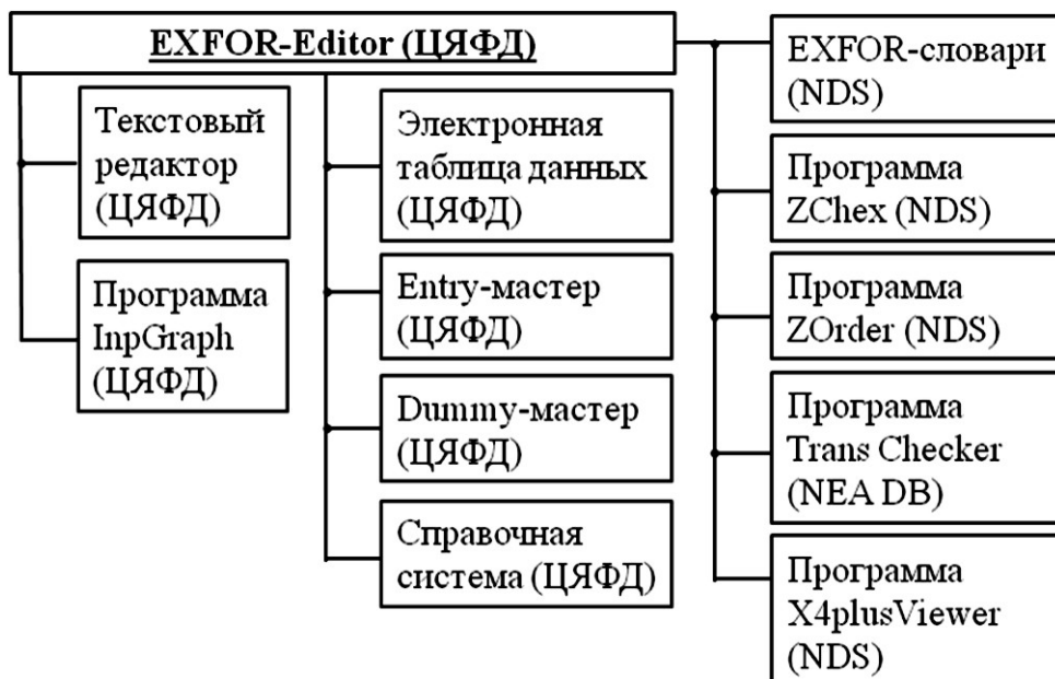
Рис. 2. Структурная схема программного комплекса EXFOR-Editor
