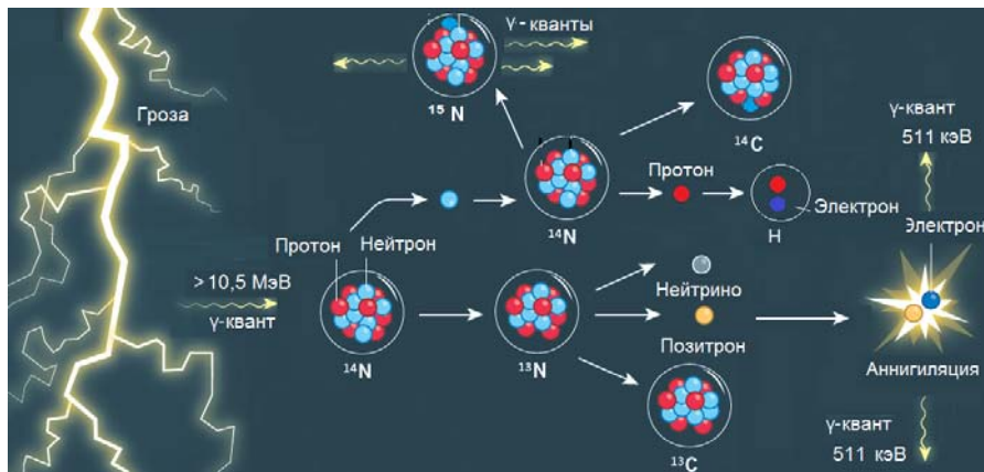
Рис. 12. Каналы реакций с участием ядер ^{14}\text{N} , инициируемых \gamma -квантом с энергией выше порога фотоядерных реакций [108]
